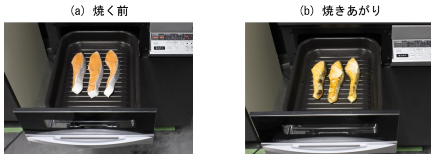
写真2. 魚焼きテスト風景(一例) [室温 20^{\circ}\text{C} ・湿度 65%]
